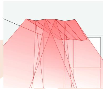
Die feine Profilierung der Oberfläche intensiviert die Strahlung, sodass der Wirkungsgrad des KlimaSegels PLUS maximal ist. Tages- und Kunstlicht werden zudem blendfrei in den Raum gestreut. (Foto: JOCO)
